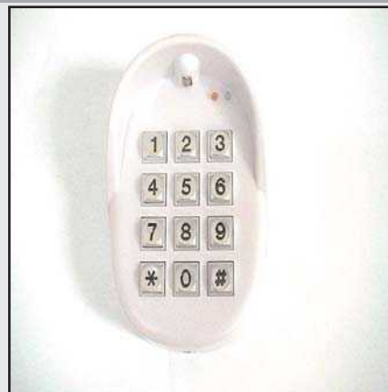
CLPEA : Clavier à codes radio ABS, 4 canaux et plus , 2 leds de signalisation d'état, fonctionne avec une pile 12v. Fonctionne avec RQ2433 et RQ2SC433A , HEAD ... Récepteurs à dips 433 Mhz (nous consulter).
