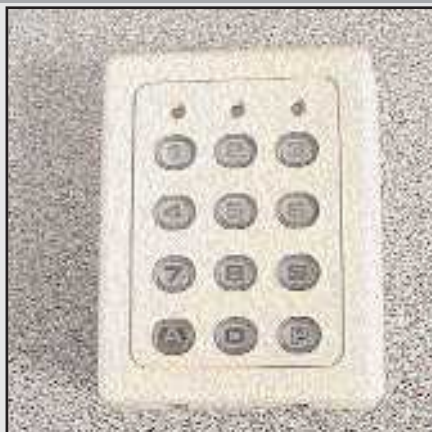
SU2 : clavier à codes en saillie, boîtier ABS, 2 relais NO NF, 12/24 V AC/DC, bi stable, impulsionnel, temporisé, rétro-éclairé anti-arrachement. 60 codes programmables en façade.
