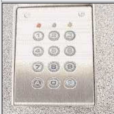
SU2SAB : clavier à codes en saillie, boîtier inox, touches rétro éclairées, 2 relais NO NF, 12/24 V AC /DC, bi stable, impulsionnel, temporisé, rétro-éclairé, anti-arrachement. 60 codes programmables en façade.
