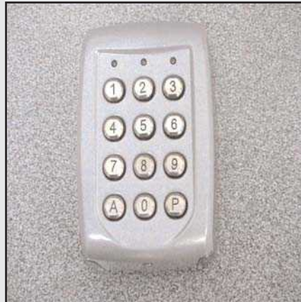
TALOS2STMG : clavier à codes en saillie, boîtier alu, touches métalliques, 2 relais NO NF, 12/24 V AC /DC, bi stable, impulsionnel, temporisé, rétro-éclairé, anti-arrachement. 60 codes programmables en façade.
