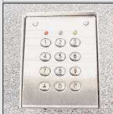
SU2SABTMG : clavier à codes en saillie, boîtier inox, touches métalliques, 2 relais NO NF, 12/24 V AC /DC, bi stable, impulsionnel, temporisé, rétro-éclairé, anti-arrachement. 60 codes programmables en façade.
