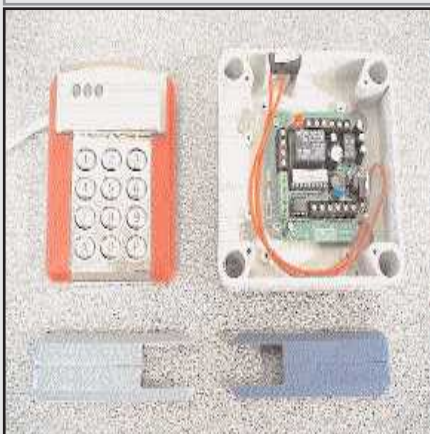
SUN : Clavier à codes autonome, 2 relais, 250 codes utilisateurs. IP67 totalement anti vandal, ultra plat. Electronique déportée . Polyvalent : contrôle d'accès, alarme, automatisme. Le Clavier sup SUNC .
