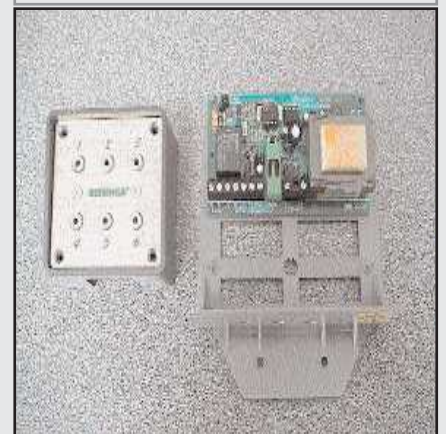
IDTAST : Clavier à codes filaire numérique BENINCA avec son récepteur.
