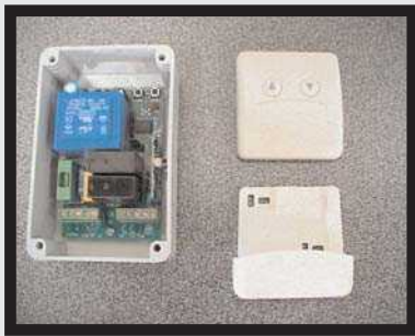
KCTR29LBEE : gestion d'éclairage par bouton poussoir radio , 2 circuits 2x1000w.
