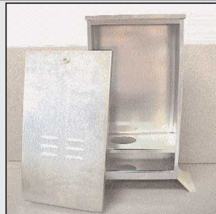
ARCG : coffret en acier galvanisé à clés Dimensions : L280xH700xP170 mm L = largeur H = hauteur P = profondeur Livré support à sceller ou à boulonner . Idéal pour l' installation d'un coffret de gestion pour moteur coulissant en copropriété et usine .
